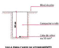
VALA PARA CABOS DE ATERRAMENTO
