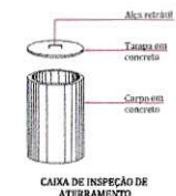
CAIXA DE INSPEÇÃO DE ATERRAMENTO
